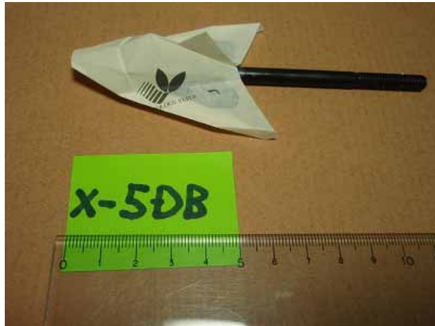
X-5DB ステルス有尾翼型 (実験一回目) 胴体部含む翼面積 2133.25平方 mm
