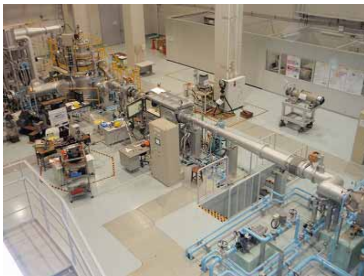
風洞装置の中央計測部
